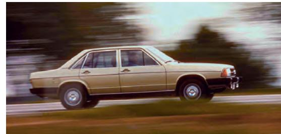
Ab Frühjahr 1977 übernahm der Audi 100 GL 5E die Rolle des Spitzenmodells der Baureihe. Sein Fünfzylinder-Einspritzmotor war eine Novität und betörte mit achtzylinderähnlichem Klang. 136 PS aus 2,2 Liter Hubraum beschleunigten die Limousine in 9,5 Sekun-
