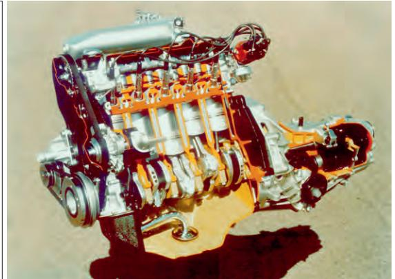
Audi 80 und 100 zum Einsatz kam. Vorgestellt wurde der erste Fünfzylinder-Ottomotor mit dem Audi 100 Typ 43 im **August 1976** in Luxemburg, die Auslieferung begann im März 1977. Der Einspritzmotor (Bosch K-Jetronic) mit 2.144 ccm Hubraum leistete 100 kW (136 PS). Im September 1979 folgte die erste aufgeladene Variante mit 125 kW (170 PS) im Audi 200 5T, 1980 der 147 kW (200 PS) starke Audi quattro. Bereits im Jahr 1978 machte die erste Dieselversion mit einer Weltfahrt von sich reden.
